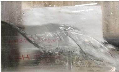
(a) 前堰、侧堰及后堰水流流态
