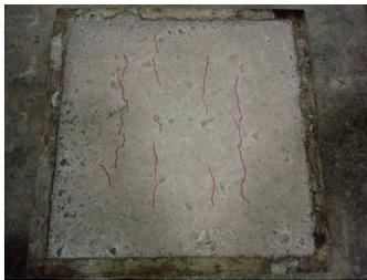
(a) 基准混凝土表面裂缝情况
