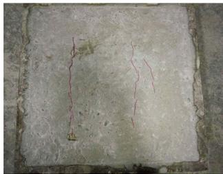
(b) MgO 混凝土表面裂缝情况
