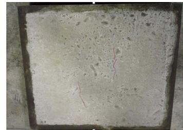
(c) 纤维混凝土表面裂缝情况
