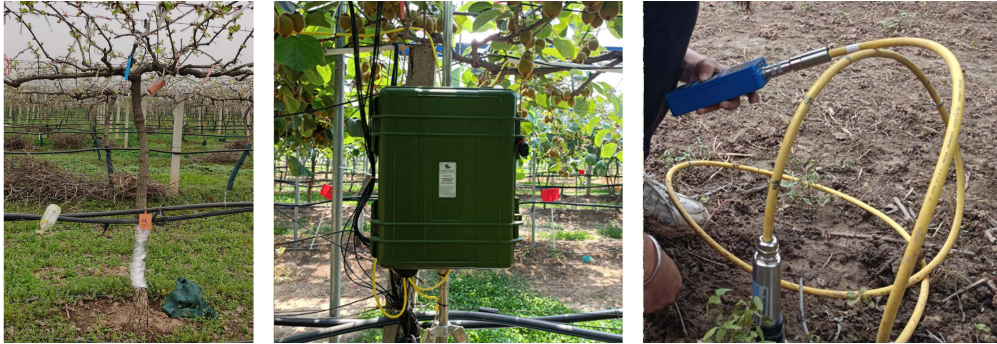
图1 液流检测系统及剖面土壤水分测量系统
