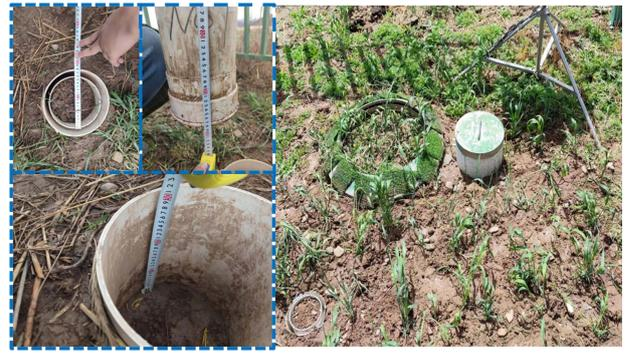
(a) 自制株间土壤蒸发仪 (b) 微型蒸渗仪
