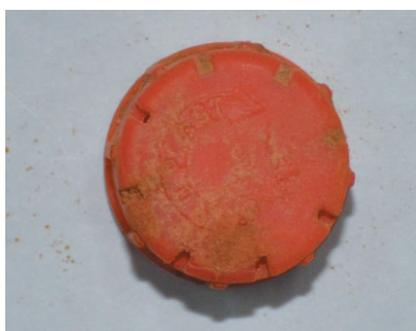
图2 灌水器出水孔外部堵塞情况
