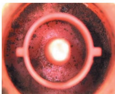
图3 显微镜下灌水器内部泥沙堵塞情况
