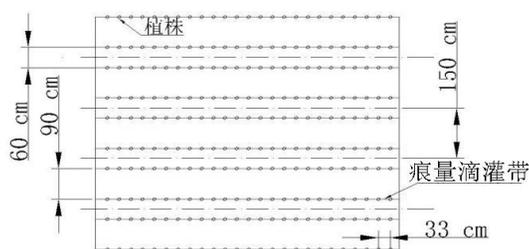
图1 痕量灌溉带布置示意图
