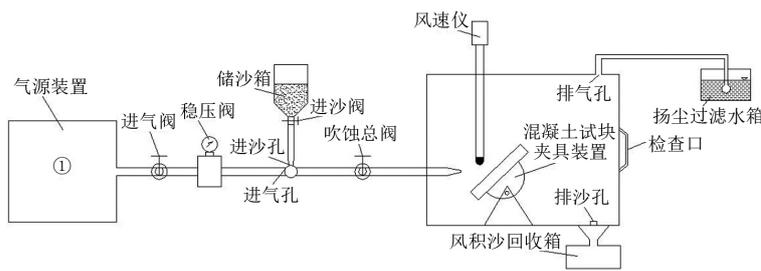
(a) 风沙吹蚀装置示意图
