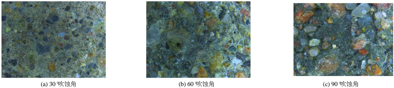
图 5 渠道混凝土表面微观形貌
