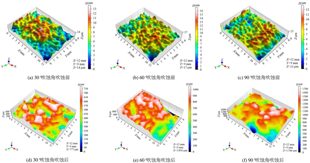
图 6 渠道混凝土表面三维形貌
