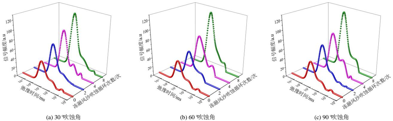
图 8 冻融-风沙吹蚀循环下  $T_2$  谱分布曲线
