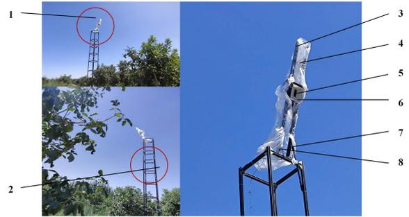
注 1.可调观测支架；2.观测架主体；3.支架固定边；4.防水布；5.热红外相机；6.3D打印相机外壳；7.电源线；8.信号线。
