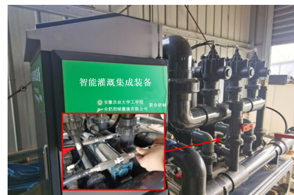
图 5 水肥一体化机整机结构
